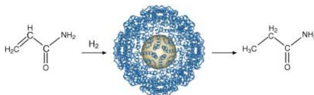
**Metalcluster in einer Proteinkapsel:** Solche *in situ* durch chemische Reduktion von Palladium(II)-Ionen im Apoferritin-Käfig erzeugte Cluster ermöglichen grö-
